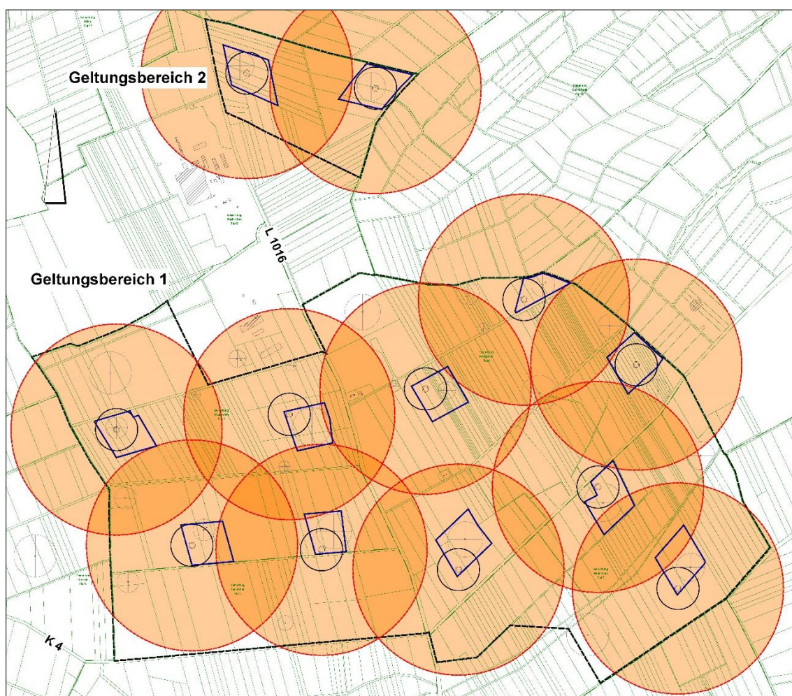
Abb. 4: Beispielanordnung innerhalb der Baufelder, Darstellung der Abstandsflächen (Radius der Abstandsflächen = 375 m, Rotorradius der Beispielanlagen = 75 m)
